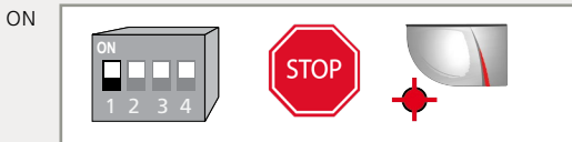
RELAIS 1: fonction STOP sur le côté ouverture de la porte.
